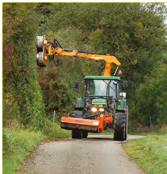
Der Schneidkopf (Skorpion) wird an einen Traktor angebaut und kann drei Arbeitsgänge gleichzeitig erledigen: Schnitt, Häckseln, Räumen.
